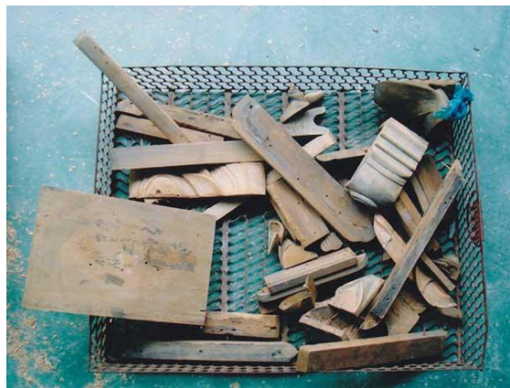
▲ 3. 熱湯による虫駆除、表面塗装の剥がし作業。後、天日乾燥
